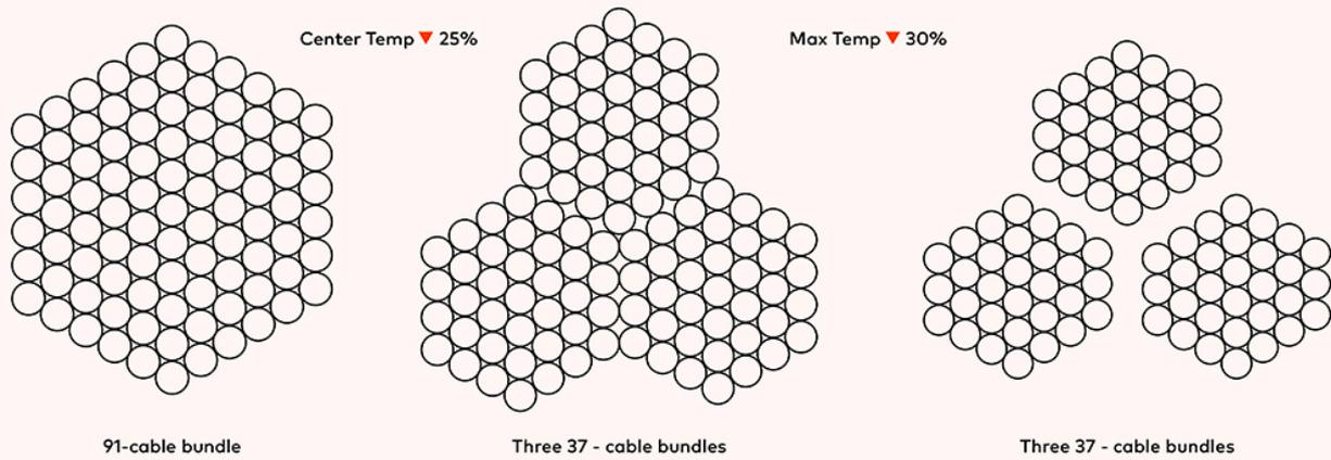
Impacto de la reducción y separación del número de cables (suponiendo cables Cat. 6A, 1000mA de 4 pares)
