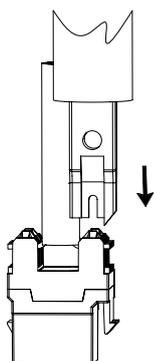
**4** Colocar la tapa de plástico, con el cable atravesándola, sobre el conector Keystone.
