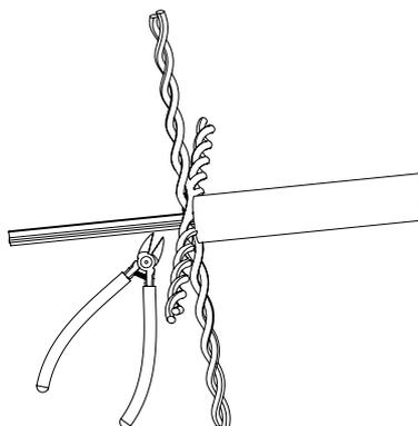
**3** Inserta los hilos en los agujeros del conector según las instrucciones para TIA568A/B en la etiqueta y córtalos.
