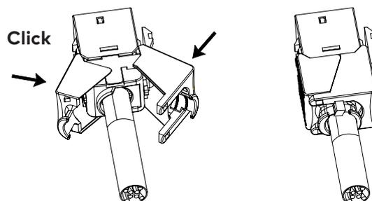
Si no tiene la cinta de cobre, conecte el hilo de drenaje a la carcasa blindada del conector.
