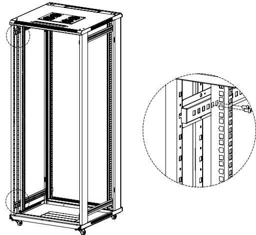
Atornilla los 4 perfiles verticales **(3)** en la posición de profundidad deseada por medio de los 16 x tornillos M6\*12 **(B)**;
