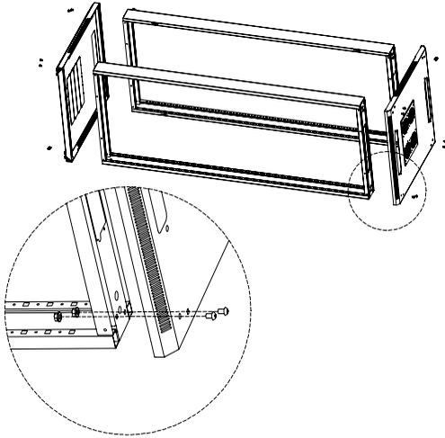
Para el primer paso necesitarás el panel superior **(5)**, el panel inferior **(8)** 2 x conjunto de marcos **(6)**. Coloca los conjuntos de marcos tumbados para atornillar los paneles con 16 tornillos M8\*12 **(C)** y tuercas M8 **(D)** como se muestra en la imagen;
