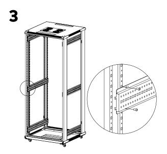
Con el armario en posición vertical, monta las 4 barras para sujetar los perfiles **(4)** con 24 x tornillos Mó\*12 **(B)** en las esquinas y centro del armario;
