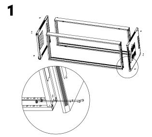
Para el primer paso vas a necesitar el panel superior **(5)**, el panel inferior **(10)** y 2 x conjunto de marco **(6)**. Coloca los conjuntos de marcos tumbados para atornillar los paneles con 16 tornillos M8\*12 **(C)** y tuercas M8 **(D)** como se muestra en la imagen.
