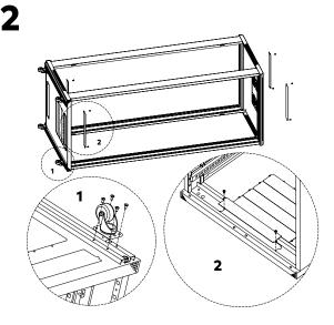
Atornilla los paneles de entrada de cables (11) a los paneles superior e inferior, y las ruedas (12) en el panel inferior por medio de 24 x tornillos M5\*10 (A);
