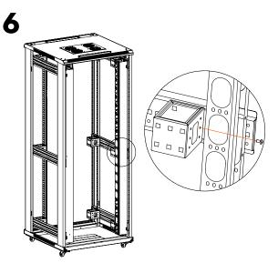
Con 12 x tornillos M5\*10 (A) fija los guía-cables verticales (7) a los espaciadores de montaje;
