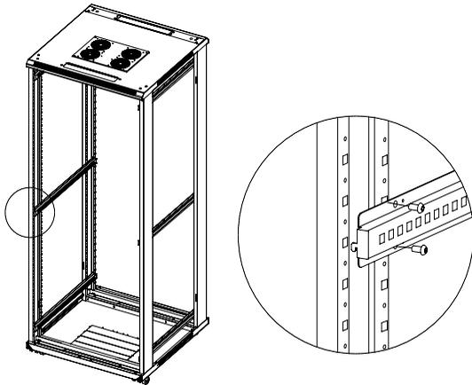
Con el armario en posición vertical, monta las 4 barras para sujetar los perfiles **(4)** con 16 x tornillos M6\*12 **(B)** en las esquinas del armario;
