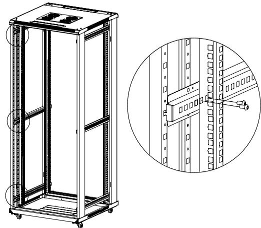
Atornilla los 4 perfiles verticales **(3)** en la posición de profundidad deseada por medio de los 16 x tornillos M6\*12 **(B)**;
