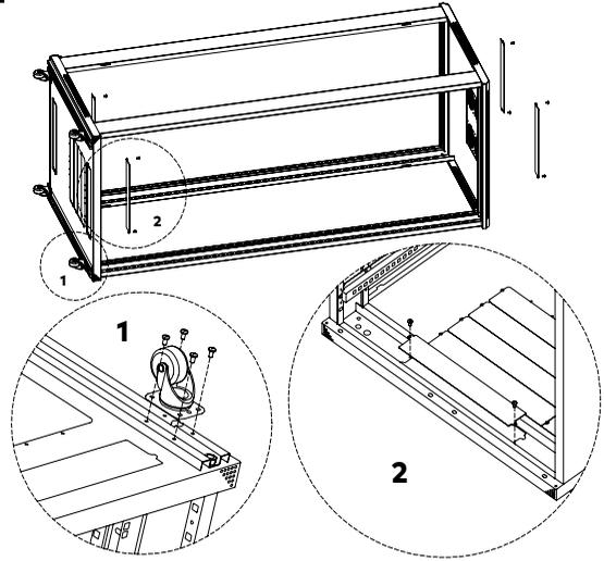
Atornilla los paneles de entrada de cables **(9)** a los paneles superior e inferior, y las ruedas **(10)**, en el panel inferior por medio de 24 x tornillos M5\*10 **(A)**;
