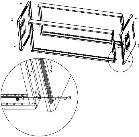
Para el primer paso necesitarás el panel superior **(5)**, el panel inferior **(8)** y 2 x conjunto de marcos **(6)**. Coloca los conjuntos de marcos tumbados para atornillar los paneles con 16 tornillos M8\*12 **(C)** y tuercas M8 **(D)** como se muestra en la imagen;
